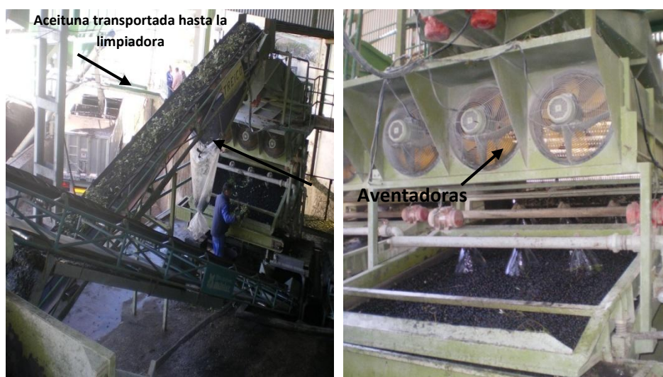
Figura 1. Limpieza de la aceituna por medio de aventadoras y ducha.
