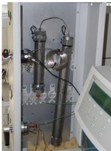
Figura 55. Columnas de GPC.
