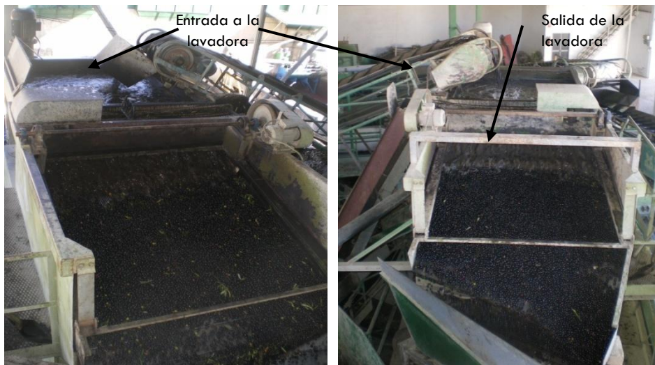
Figura 3. Lavado de aceitunas en lavadoras.
