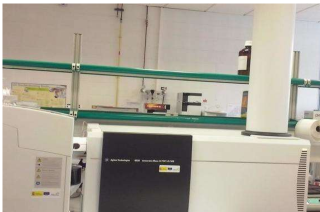
Figura 24. Espectrómetro de masas Agilent 6530B unido a un cromatógrafo de líquidos de alta resolución Agilent 1200.
