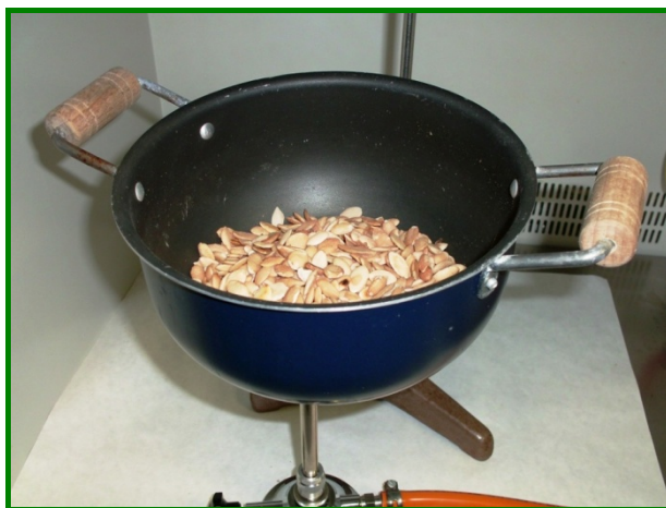
Fig. 3.3. Torrefacción de almendra, en cazo con orificios, sobre mechero Bunsen
