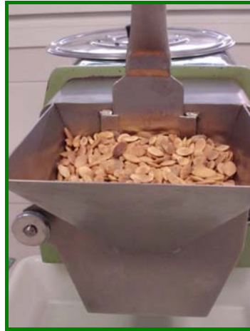
Fig. 3.5. Molino de martillos MC2, modelo 100
