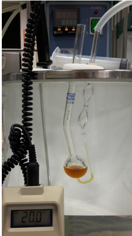
Fig. 3.7. Viscosímetro capilar Cannon-Fenske, Afora nº 26349, serie 300
