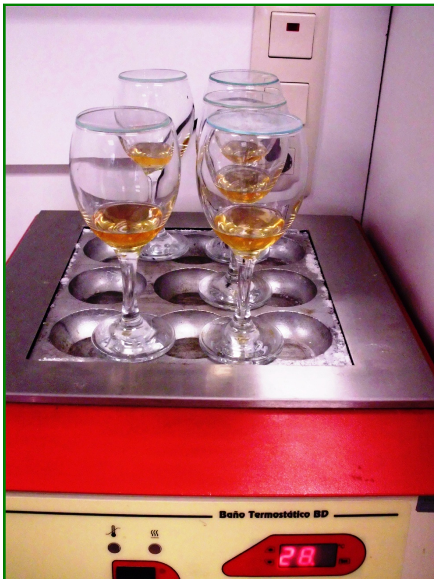
Fig. 3.8 Copas para la cata del aceite de argán, a una temperatura de 28^\circ\text{C}
