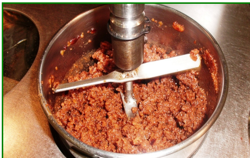
Fig. 3.6. Termobatidora MC2, modelo 100
