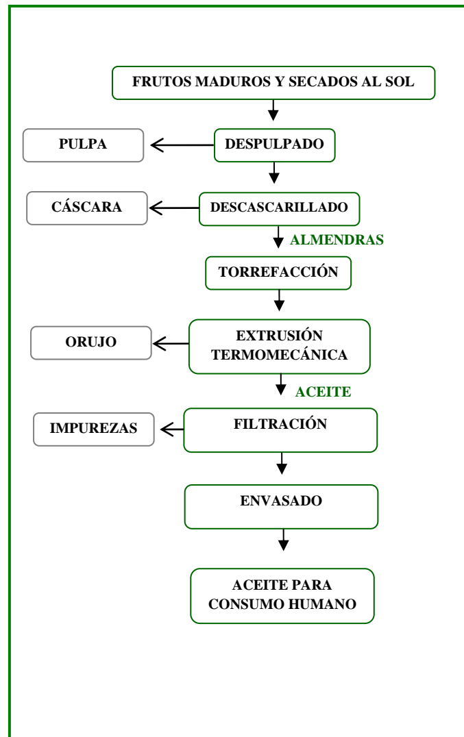
Fig. 2.12. Extracción del aceite de argán por el método semi-industrial
