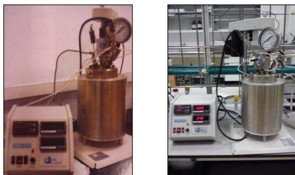
Figura 3.6 Dispositivo experimental para los tratamientos hidrotérmicos.
