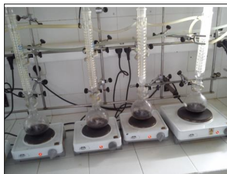
Figura 3.18 Determinación de FAD. Ebullición con condensación a reflujo.
