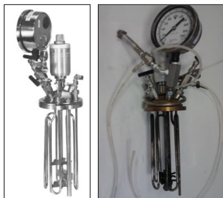
Figura 3.8 Tapa, turbina de agitación y serpentín interno del reactor.
