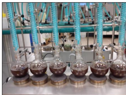
Figura 3.19 Determinación de LAI. Ebullición con condensación a reflujo.
