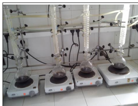
Figura 3.17 Determinación de FND. Ebullición con condensación a reflujo.
