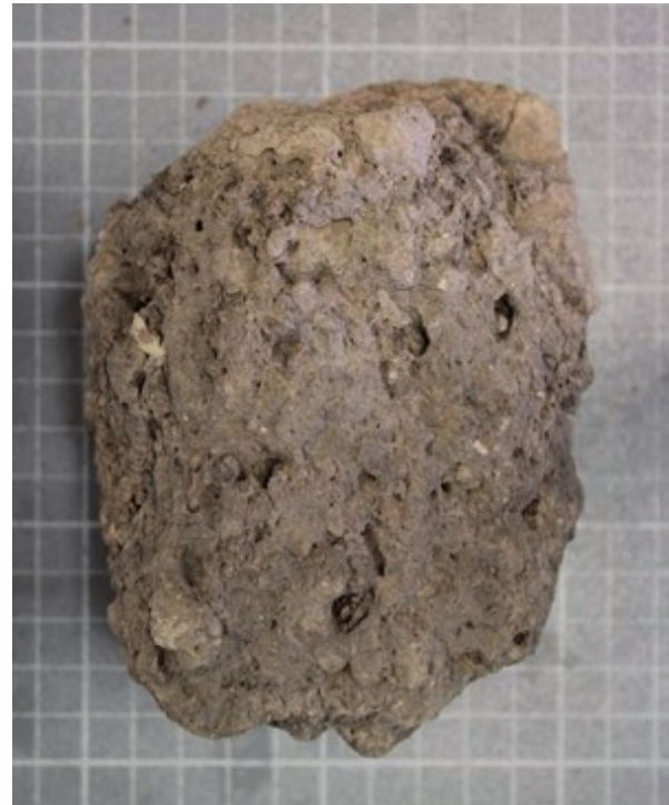
Figura 8. Ladrillos conformados en frío quemados por acción del incendio
