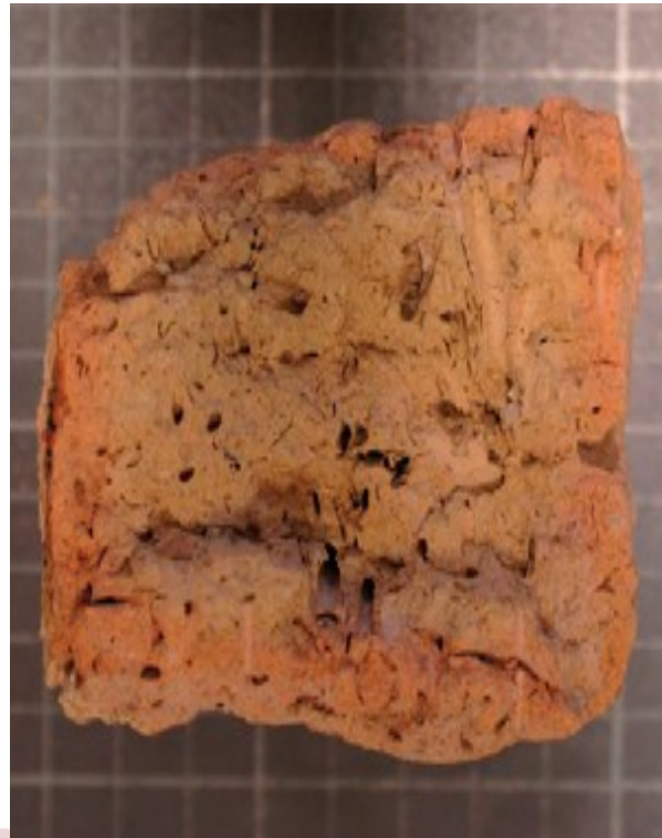
Figura 10. Cerco rojo presente en los ladrillos conformados en frío
