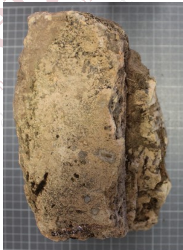
Figura 12. Mortero adherido a un ejemplar de ladrillo conformado en frío
