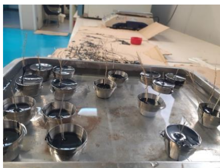
Figura 6. Probetas de betún 100% terminadas para su ensayo.
