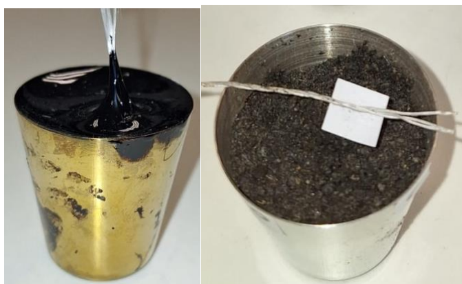
Figura 13. Aspecto de una probeta con matriz de betún 100% al final del ensayo (izda.) y aspecto de una probeta con matriz de mezcla bituminosa al final del ensayo (dcha.).
