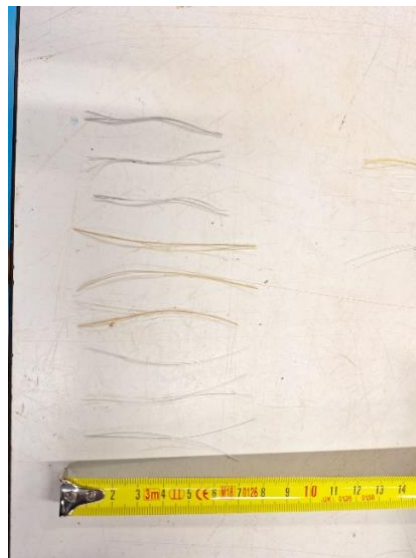
Figura 5. Longitudes de las diferentes fibras ensayadas.
