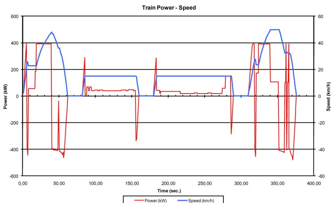
Figura 3.1. Curva Potencia-Velocidad típica del tranvía del tramo de la línea 1 entre las paradas 21 y 25.
