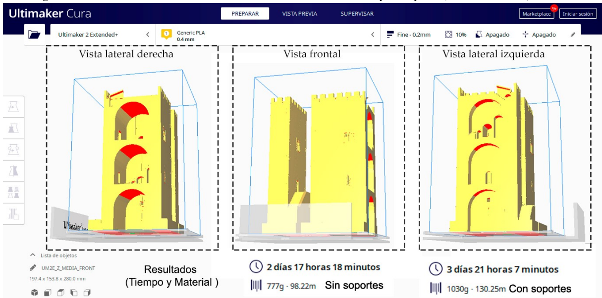
Fig. 8. Resultados obtenidos mediante el software Ultimaker Cura V4.5 con y sin soportes ( Pieza Tras y Front a la vez ).
