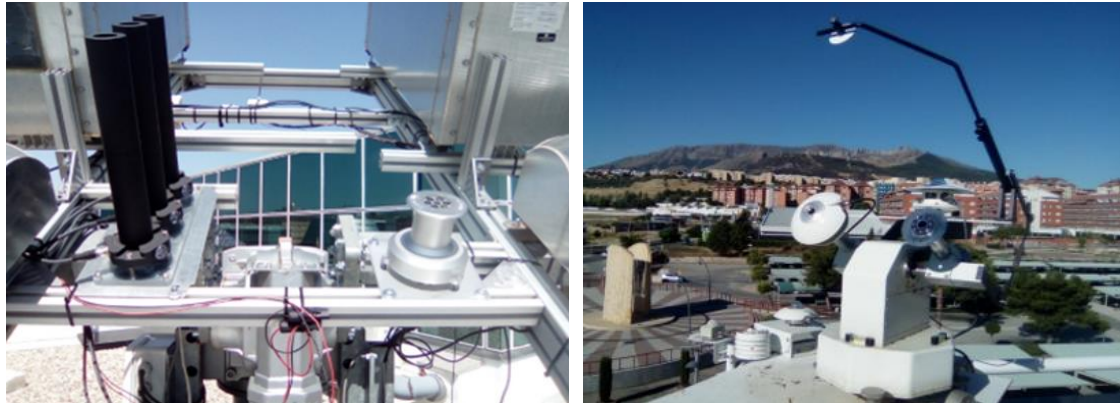
Figura 11. Espectroradiómetro SolarSIM-D2 de Spectrafy junto con sensor Isotypes (izquierda) y estación meteorológica GEÓNICA 3000C (derecha) situada en la terraza del CEAETEMA (Universidad de Jaén).
