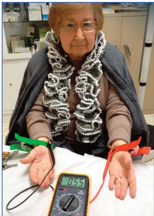
Figura 35: Medida de la resistencia de la piel. Fuente: Elaboración propia.
