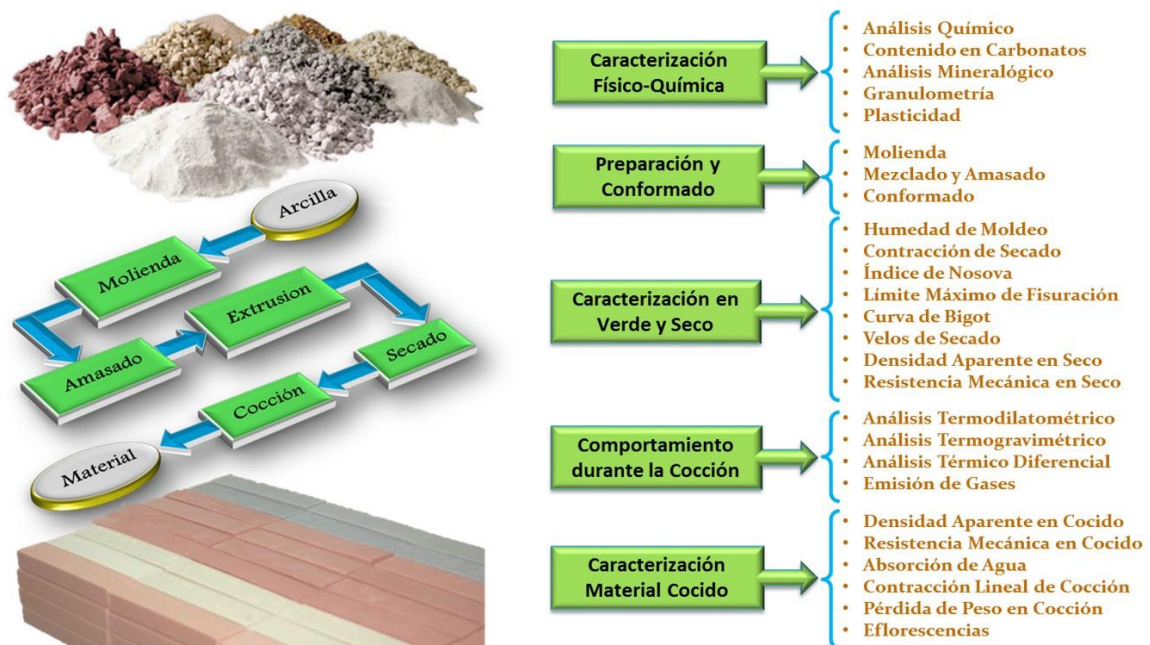
Figura 3.2: Representación esquemática de la secuencia de etapas de procesamiento y caracterización llevada a cabo para el estudio de los materiales (elaboración propia)
