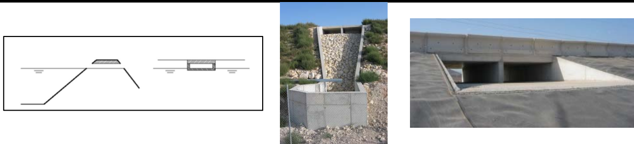
Figura 1. Esquema y fotografías de aliviaderos de canal rectangular (aporte frontal del caudal de vertido). Balsa “El Toscar” Monóvar [2].
